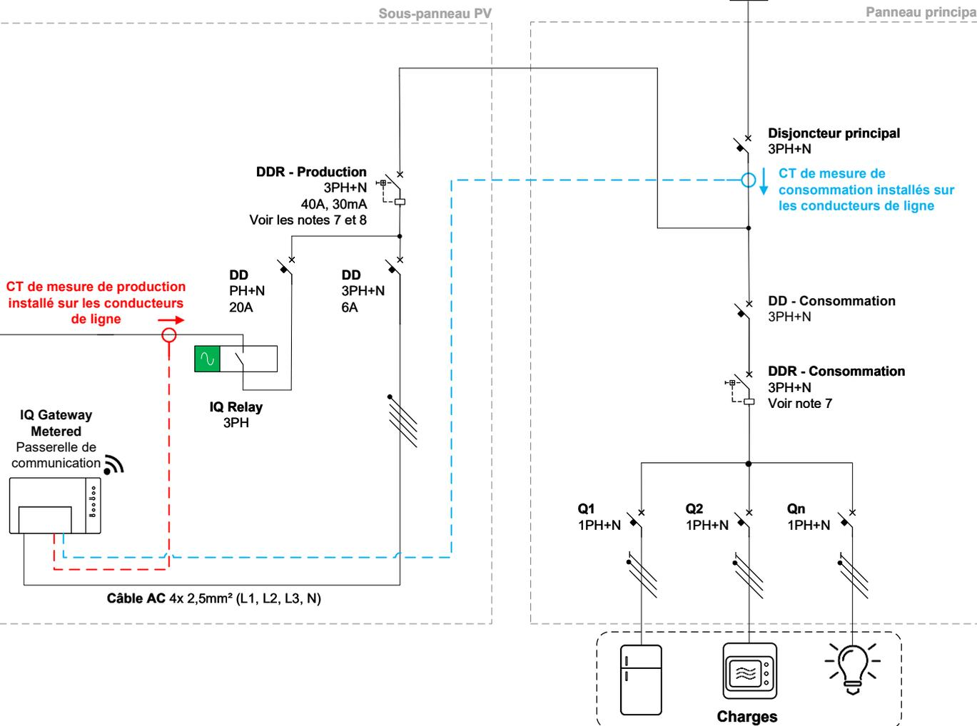
**CT de mesure de production installé sur les conducteurs de ligne**
